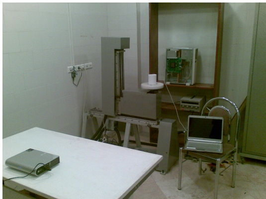
شکل ۱۲- سیستم تصویربرداری نوری طراحی و ساخته شده
