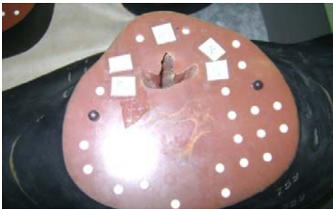
شکل ۵- نحوه قرار گرفتن دوزیمترها در داخل فانتوم در ناحیه تیروئید
