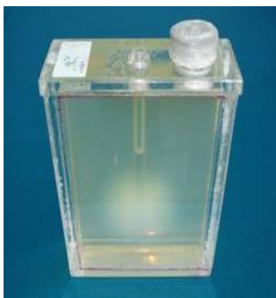
شکل ۱- تصویر فانتوم طراحی شده از جنس پرسپکس جهت ارزیابی توزیع دوز در براکی تراپی داخل حفره ای تومورهای مری
