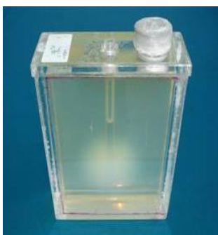
شکل ۱- تصویر فانٹوم طراحی شده از جنس پرسپکس جهت ارزیابی توزیع دوز در براکی تراپی داخل حفره ای تومورهای مری
