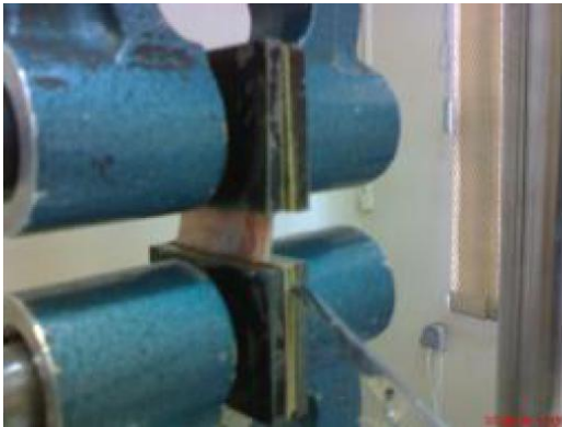
شکل ۵- آزمایش بیومکانیکی اندازه گیری استحکام زخم
