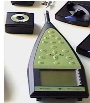
شکل ۱- نمایی از دستگاه ترازسنج صوت Investigator 2260 و کالیبراتورهای مورد استفاده در این تحقیق
