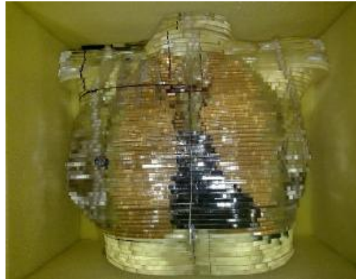
شکل ۱- فانتوم لایه ای ساخته شده از کورک و پلکسی جهت دزیمتری
