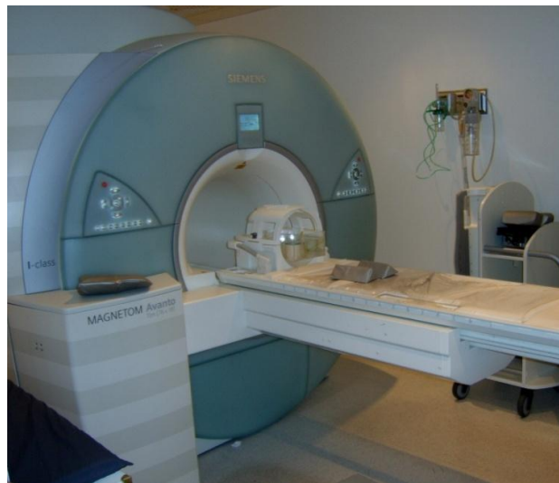
شکل ۲- نمایی از مرحله تصویربرداری ام آر آی از فانتومهای استوانه ای ژلی و لوله های کالیبراسیونی
