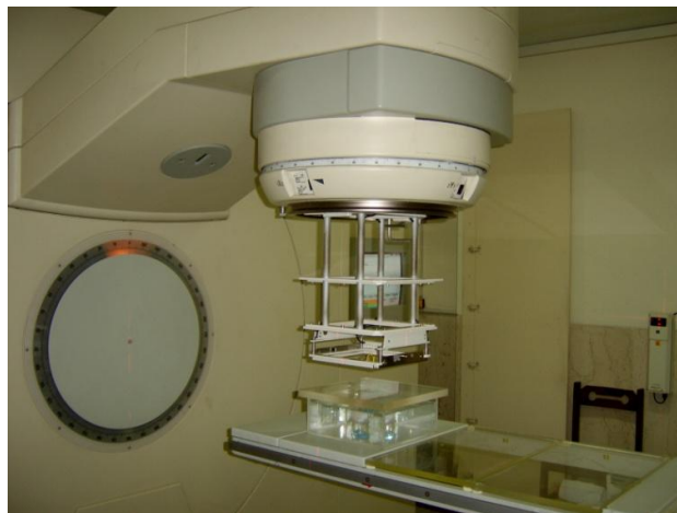
شکل ۱- نمایی از مرحله تابش دهی به فانتوم و لوله های کالیبراسیونی به کمک شتاب دهنده خطی
