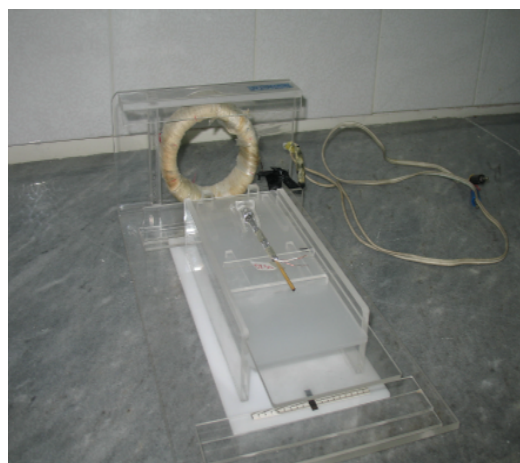
شکل ۴- محل قرار گرفتن کویل مولد میدان مغناطیسی، کویل جستجوگر و گوس متر
