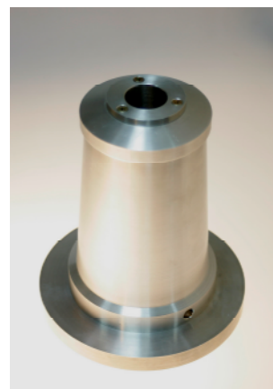
شکل ۳- اتاقک یونش چاهک‌دار ساخته شده
