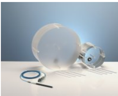
شکل ۱- فانتوم های ساخته شده ی استاندارد سروتنه دوزیمتری سی تی اسکن
