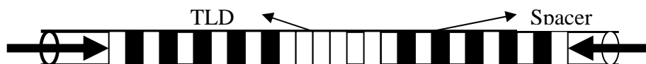
شکل ۲- نحوه قرار گرفتن TLD ها و پلاستیک ها در لوله استوانه ای
